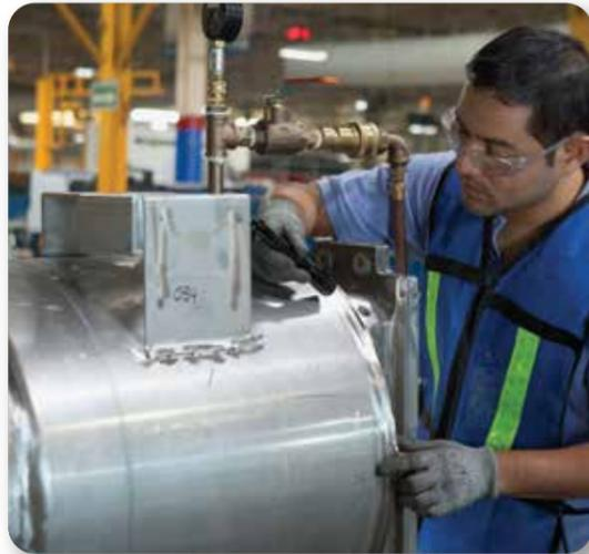
Jeder Druckbehälter wird einzeln untersucht, und es wurden hydrostatische Drucktests durchgeführt.
